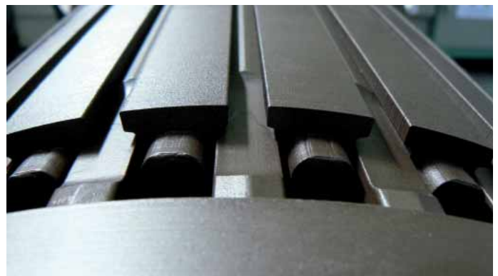
Rotor d'une machine de traction d'une puissance supérieure à 250 kW // Rotor of a tensile machine of over 250 kW // Anker van een aandrijfmachine met een vermogen van meer dan 250 kW
