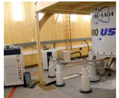
À gauche, diffractomètre de poudres, équipé d'une chambre haute température. Au centre, diffractomètre de rayons X. À droite, spectromètre RMN 900MHz // Left, a powder diffractometer with a high-temperature chamber. Centre, an X-ray diffractometer. Right, an NMR spectrometer // Links, diffractometer van poeder met hoge-temperatuurkamer. In het midden, diffractometer van röntgenstralen. Rechts, spectrometer RMN 900MHz
